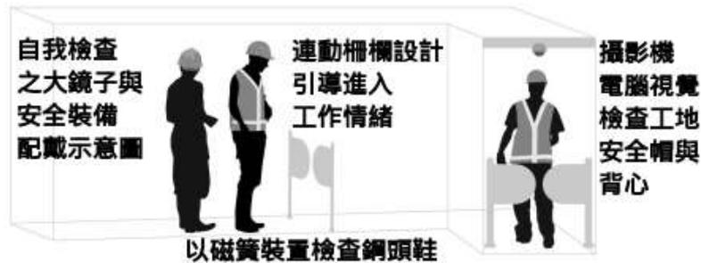
圖一：在工地入口設置營建工地安全系統
