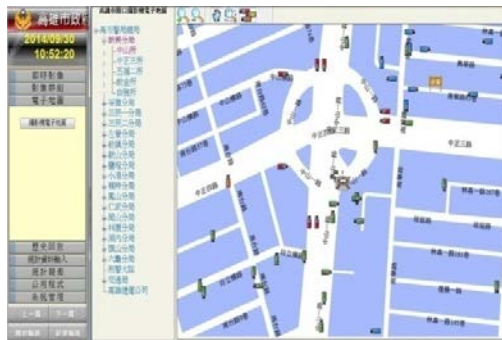
圖四:錄影監視調閱平台系統之地理資訊系統功能示意圖
