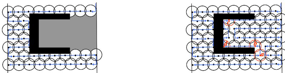
(a) 簡易蛇行狀佈法產生的空洞有內凹的情形。 (b) 本論文的蛇行狀佈點克服內凹的障礙物情形。
